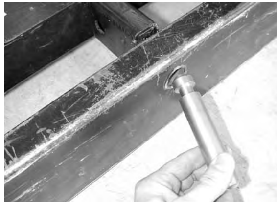
(iv) Insert locator pin
